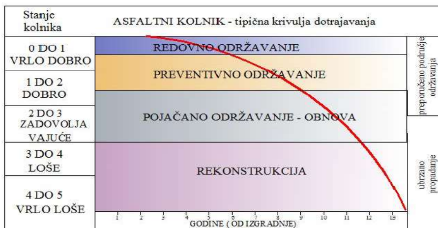
Slika 3. Tipična linija dotrajanja asfaltnog kolnika
