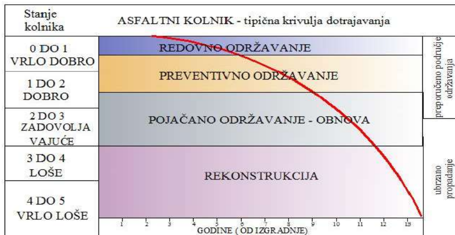
Slika 3. Tipična linija dotrajavanja asfaltnog kolnika
